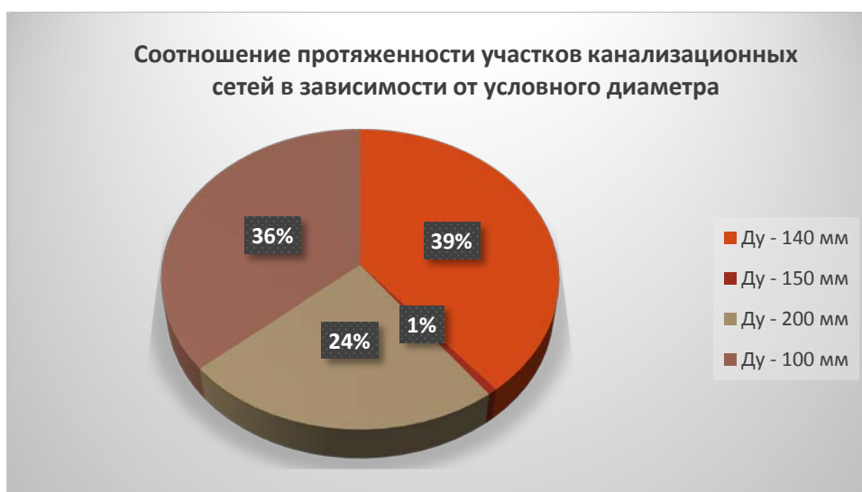
Рисунок 10-4. Структурная характеристика канализационных сетей
