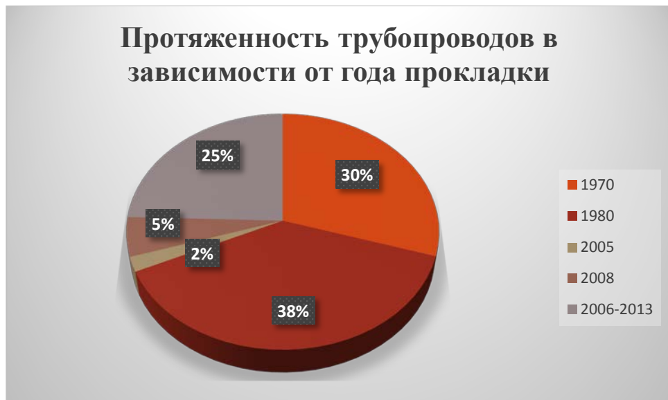
Рисунок 2-7. Структурная характеристика сетей в зависимости от года прокладки.
